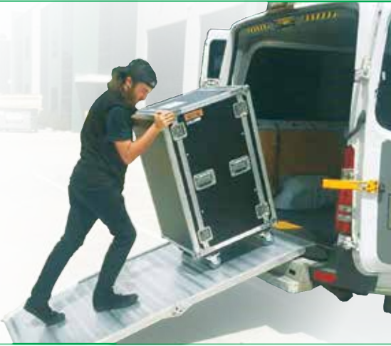
السطح المائل يساعدنا على رفع الصندوق بقوة أقل.
